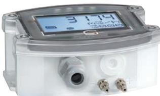
Электронный датчик и реле давления **PREMASREG® 716x** служат для измерения объемного расхода, разности давлений и уровня жидкости, а также контроля работы фильтров на основании измерения давления в чистом воздухе. Данные приборы оснащены релейным выходом, аналоговым выходом и дисплеем с подсветкой для настройки порога переключения и индикации измеренного давления. Пьезорезистивный измерительный элемент гарантирует высокую достоверность и точность.
